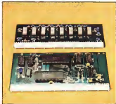
A sinistra: in basso la scheda floppy disk controller, in alto l'interfaccia per la sistema e le due stampanti parallele. Qui sopra, la scheda CPU/DMA e una scheda RAM con 8 chip da 64 bit ciascuno (totale 64 K byte).
